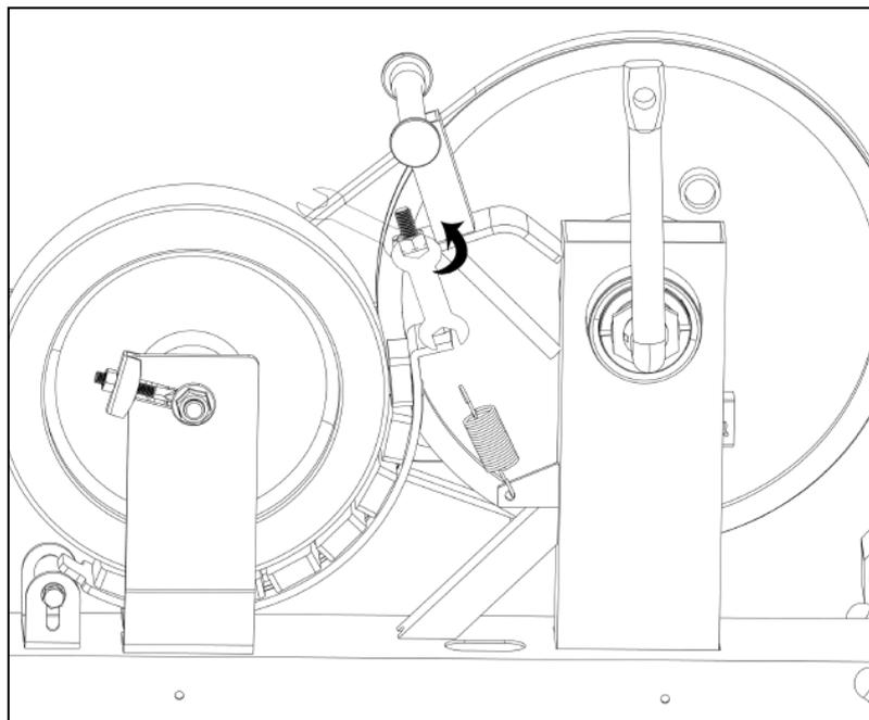
7. Wenn Sie nach Schritt 5 und Schritt 6 immer noch Geräusche hören, entfernen Sie bitte die **Kettenabdeckung (Nr. 65L/R)**. Lösen Sie die Schrauben für das **Schwungrad (Nr. 94)** um etwa eine halbe Umdrehung. Siehe nachfolgende Abbildung.
