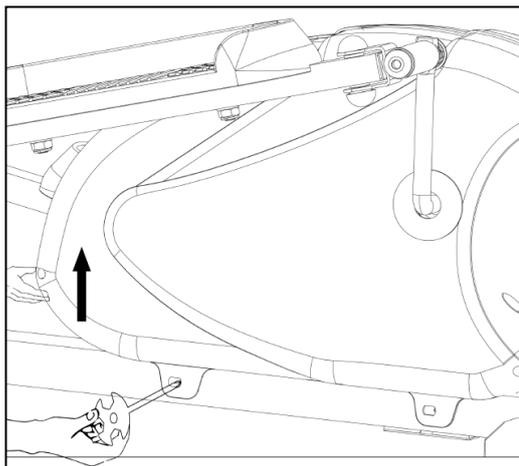
6. S'il est très difficile de pédaler aux niveaux de tension les plus élevés, ou si des bruits de frottement se font entendre, retirer le **Couvercle de courroie (N° 65L/R)** et ajuster les vis figurant dans l'illustration suivante.
