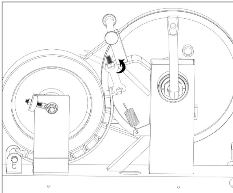
7. Si les bruits persistent après avoir accompli les étapes 5 et 6, retirer le **Couvercle de Courroie (N° 65L/R)**; desserrer les vis du **Volant d'Inertie (N° 94)** d'environ un demi-tour. Voir l'illustration suivante.
