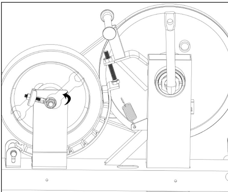
8. Si l'appareil semble instable, régler le **Capuchon de Nivellement (N° 5)** sur le **Stabilisateur Arrière (N° 3)** en le tournant. Si l'appareil est bancal à l'utilisation, envisager d'installer un tapis d'exercice en dessous.
