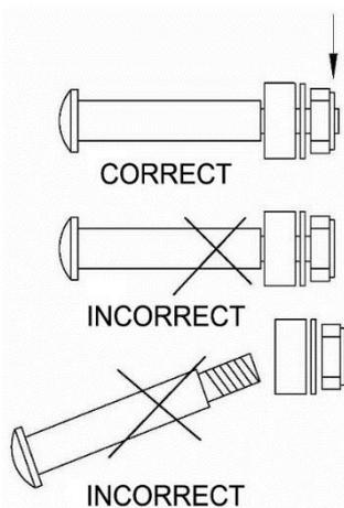
Los **Tornillos de Bisagra (n.º 19L/R)** deben ingresar completamente en los anillos de nylon de las **Tuercas de Nylon (n.º 40 L/R)**. Esto asegurará la estabilidad y durabilidad de su Entrenador Elíptico. El extremo de la **Tuerca de Nylon (n.º 40L)** Izquierda es azul, mientras que la **Tuerca de Nylon (n.º 40R)** derecha es blanca. Asegúrese de girar la **Tuerca de Nylon (n.º 40L)** Izquierda *hacia a la izquierda* y la **Tuerca de Nylon (n.º 40R)** derecha *hacia a la derecha*.
