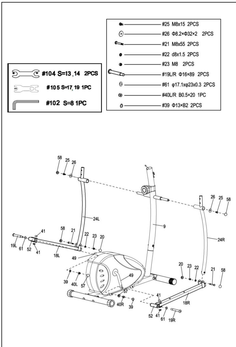
**WICHTIG:** Die **Scharnierbolzen (Nr. 19L/R)** sind mit L für LINKS und R für RECHTS gekennzeichnet. Bitte achten Sie darauf, dass Sie die **Linke Scharnierschraube (Nr. 19L)** gegen den Uhrzeigersinn und die **Rechte Scharnierschraube (Nr. 19R)** im Uhrzeigersinn drehen.
