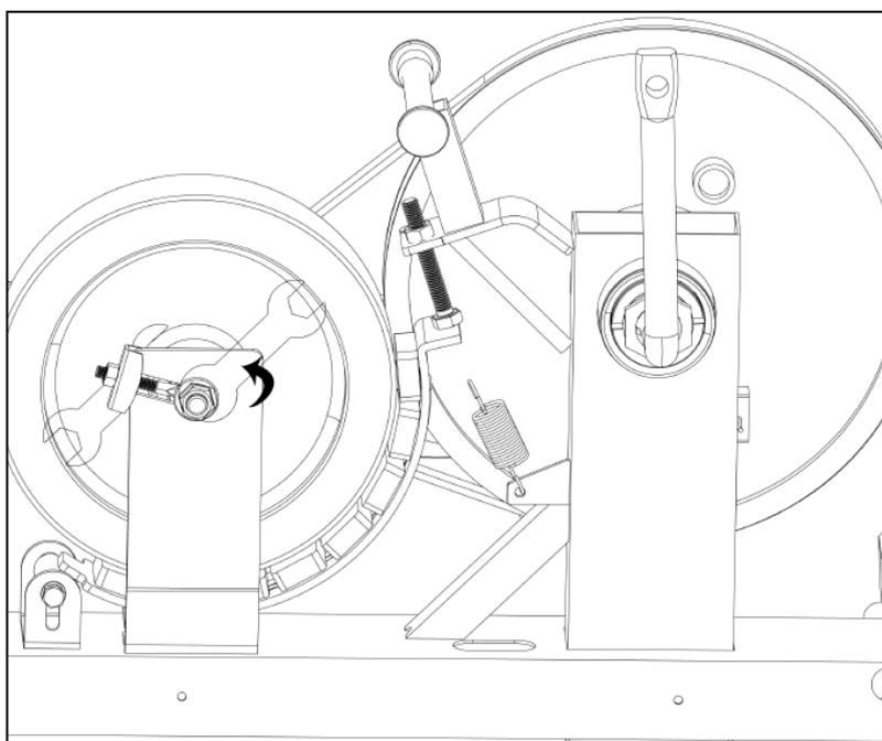
8. Wenn Sie das Gefühl haben, dass die Maschine uneben aufliegt, richten Sie bitte die **Nivellierkappe (Nr. 5)** des **Hinteren Stabilisators (Nr. 3)** durch Drehen aus. Wenn das Gerät bei der Benutzung wackelig ist, empfehlen wir Ihnen, eine Trainingsmatte unter die Maschine zu legen.
