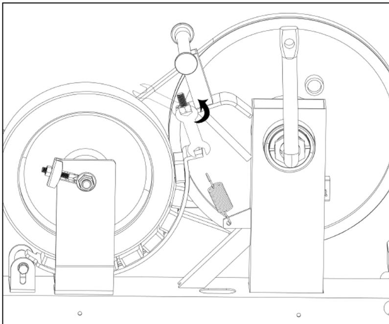
7. Si sigue escuchando ruidos después de realizar los pasos 5 y 6, retire la **Cubierta de Correa (n.º 65 L/R)** y afloje media vuelta los tornillos del **Volante de Inercia (n.º 94)**. Consulte el siguiente diagrama.
