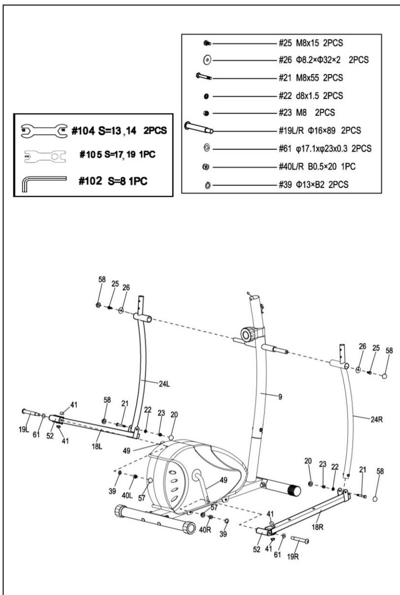
**¡IMPORTANTE!** El **Tornillo de Bisagra (n.º 19L/R)** está marcada con L para **IZQUIERDA** y R para **DERECHA**. Asegúrese de ajustar el **Tornillo de Bisagra Izquierda (n.º 19L)** hacia la izquierda y **Tornillo de Bisagra Derecha (n.º 19R)** hacia la derecha.
