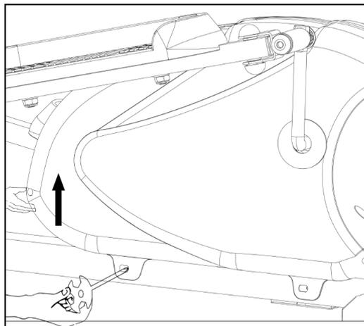
6. Wenn das Treten auf den höheren Spannungsniveaus sehr schwer ist oder Sie Reibungsgeräusche hören, entfernen Sie bitte die **Kettenabdeckung (Nr. 65L/R)** und verstellen Sie die Schraube wie in der folgenden Abbildung dargestellt.
