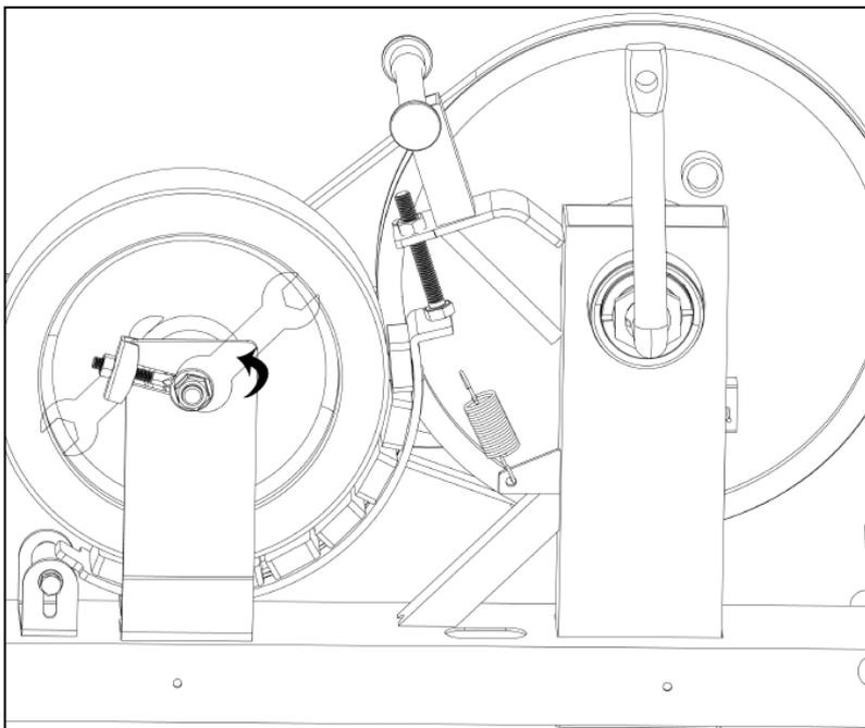
8. Si siente que la máquina no está desnivelada, gire la **Tapa Niveladora (n.º 5)** en el **Estabilizador Trasero (n.º 3)** hasta nivelarla. Si al utilizarla, la máquina está inestable, coloque una colchoneta debajo de ella.
